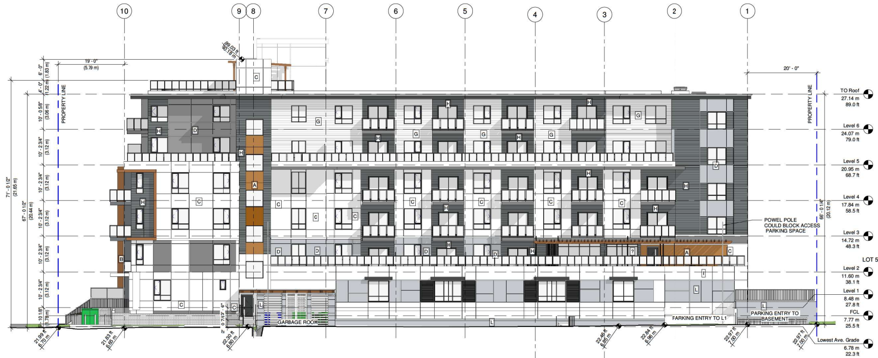
1 East Elevation (Lane) 1 : 100
